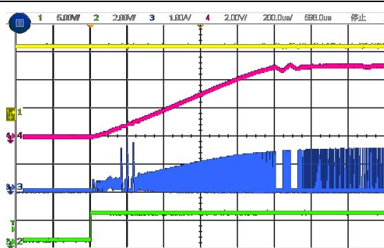
CH1:  $V_{IN}$  CH2:  $V_{EN}$  CH3:  $I_{ind}$  CH4:  $V_{OUT}$
