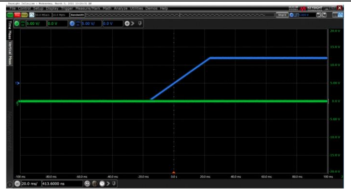
Blue>>AVCC, Green>>DAC OUTPUT AVSS = AV EE = AGND, AV CC = 0 to 12 V
