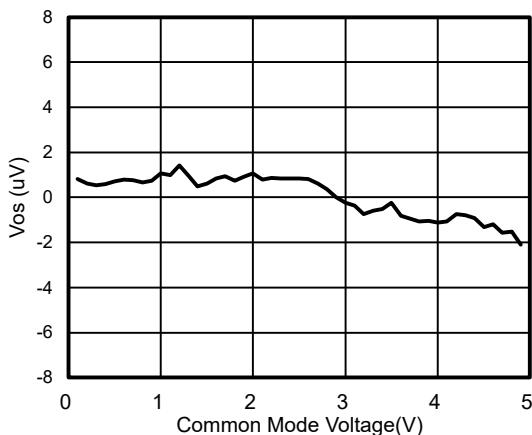
**Figure 7. V<sub>os</sub> vs. V<sub>cm</sub>**
