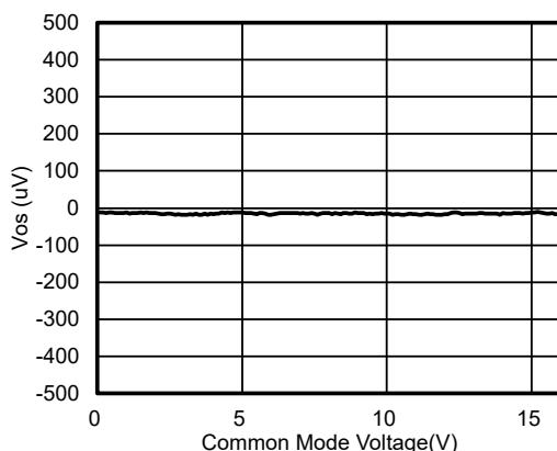
**Figure 7.** V<sub>os</sub> vs. V<sub>cm</sub>, V<sub>s</sub> = 16 V
