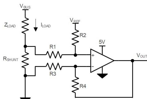
$$V_{\text{OUT}} = (I_{\text{LOAD}} \times R_{\text{SHUNT}}) \times (R_2 / R_1) + V_{\text{REF}}$$
